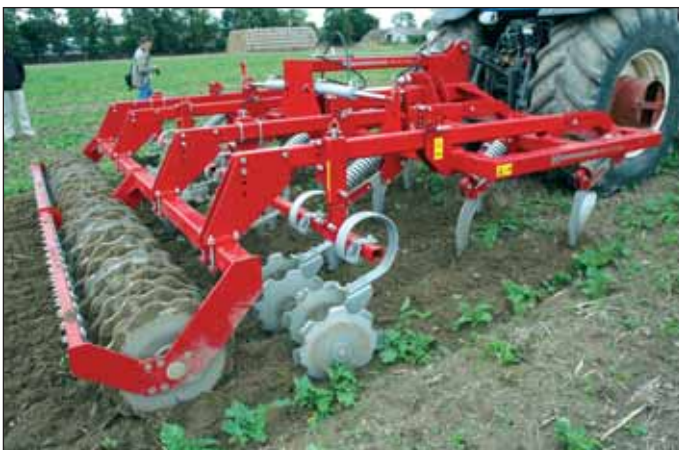
Nový radličkový kyprič Kongskilde dostal názov Delta Flex. Po odmontovaní krídiel pracuje do hĺbky 25 cm. Druhá tanierová sekcia je vymeniteľná za zavlačovač. Takisto je možné meniť tento kotúčový valec za prúťový.
