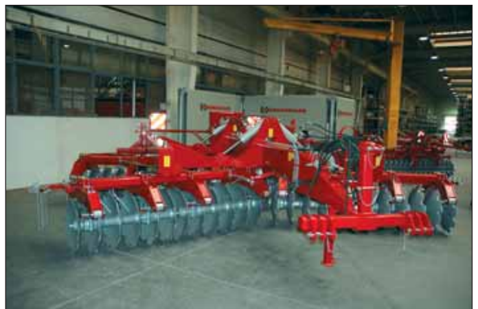
V Poľsku lakujú len červenou a striebornou farbou napr. aj ťažké tanierové náradie Terra-X. Hmotnosť stroja možno zvýšiť pridaním vody do rámu. Na záber 7 m prislúcha 56 kotúčov.
