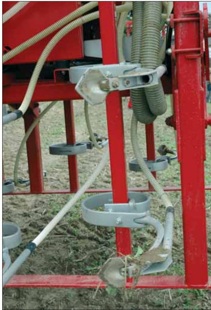
Detailný pohľad na výsevné pätky. Vzdialenosť 60 cm je medzi pätkami na jednom nosníku, ako aj medzi jednotlivými radmi. 60 cm je aj výška rámu. Medziriadková vzdialenosť je 15 cm.
