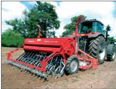
Demeter Classic – jednoduchá mechanická sejačka s diskami alebo pätkami, šírka 3 a 4 m
