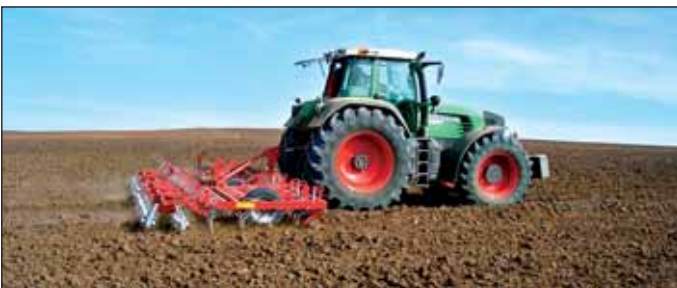
Vibro Master 2500 – jednoduchý nesený pôdny kultivátor pre veľké plochy so záberom 6,5 až 8,5 m
